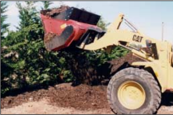
Engin mobile de type chargeur muni d'un godet broyeur
