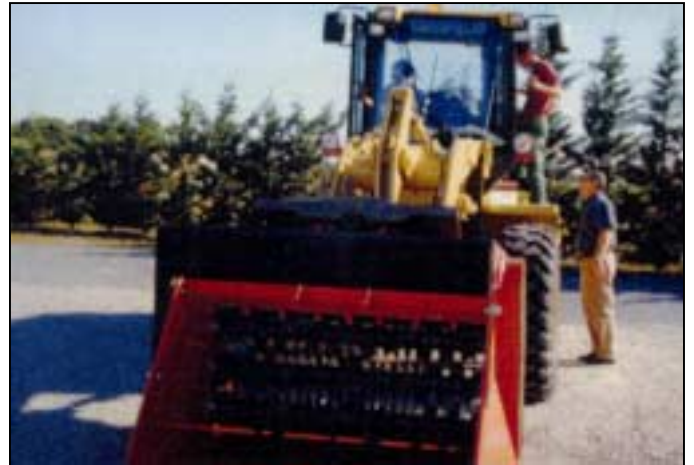
Vue du godet équipé d'axes munis de marteaux pour couper, broyer et mélanger les éléments
