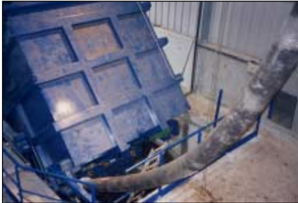
Pompage des boues pour une adjonction de support carboné (écorces ou déchets verts broyés)
